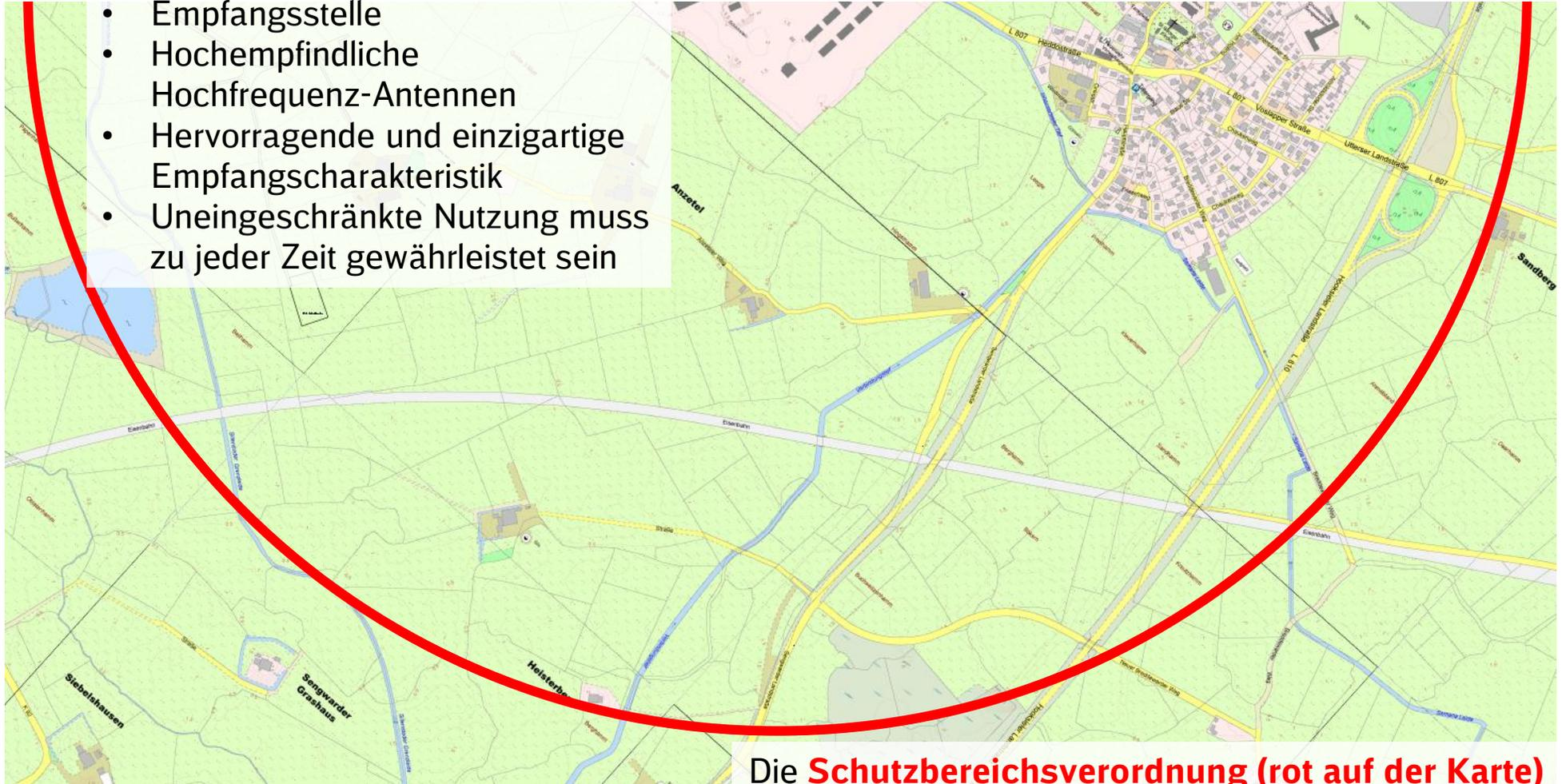
Die **Schutzbereichsverordnung** (rot auf der Karte) untersagt den Betrieb von elektrischen Bahnen im Umkreis von **1.500 m** von der Empfangsstation. Geringster Abstand der Bahnstrecke: ca. 900 m
